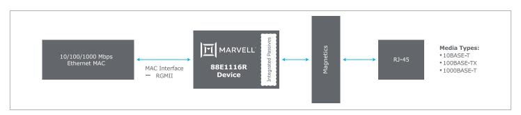
Fig 2. 88E1116R System Diagram
