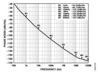
Figure 9. Open-Loop VCO Phase Noise, 8.0 GHz, VCC\_VCO = 5 V
