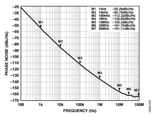
Figure 8. Open-Loop VCO Phase Noise, 5.7 GHz, VCC\_VCO = 5 V
