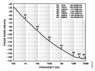
Figure 7. Open-Loop VCO Phase Noise, 4.0 GHz, VCC\_VCO = 5 V
